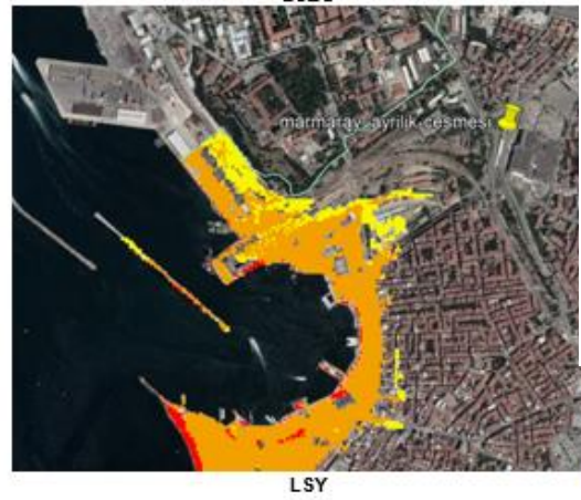
Şekil 10.7 Marmaray Aynalık Çeşmesi İstasyonu su baskını
