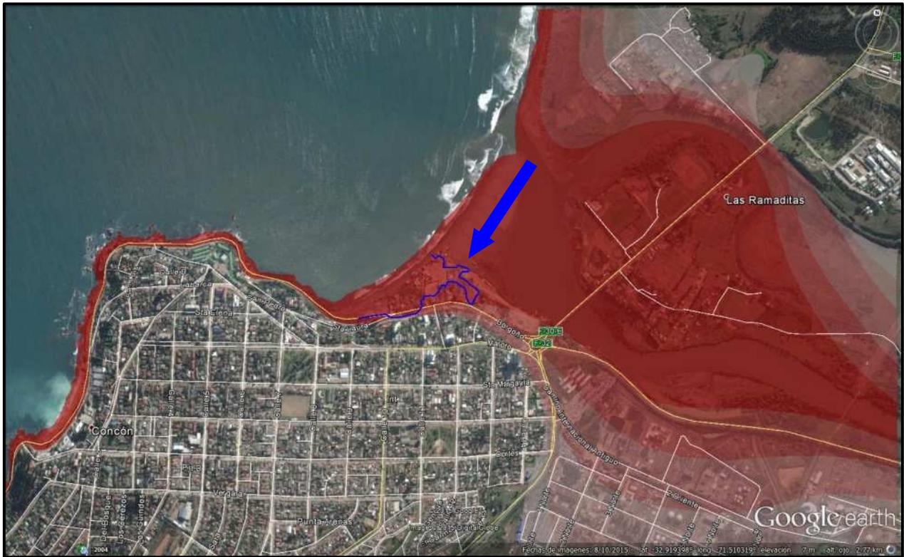
Figura 21. Medida en terreno de la línea de inundación Concón. La línea azul representa el área inundada por el tsunami del 16 de septiembre de 2015 y el área roja la inundación obtenida para un evento extremo simulado para la Carta de Inundación por Tsunami (CITSU) vigente.
