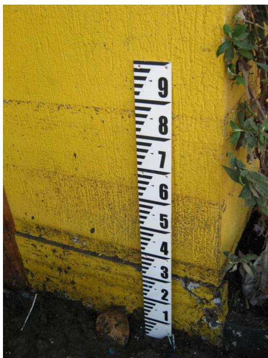
Figura 20. Profundidad de inundación del Tsunami en Restaurant (0.88 m) ubicado en el sector de Playa La Boca, Concón.
